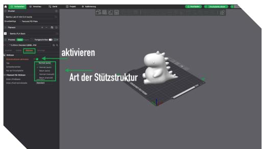
Menüpunkt: Vorbereiten Untermenü: Stützen Aktivieren der Stützstruktur und Typauswahl (Normal, Baum, manuelle, automatisch)
